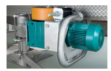
Aucun incident: Les galets de roulement particulièrement robustes et conçus sans entretien soutiennent la plate-forme. A la différence d'autres systèmes sans roulement à bille. Cela signifie moins d'interruption coûteuse de fonctionnement pour l'entretien.
